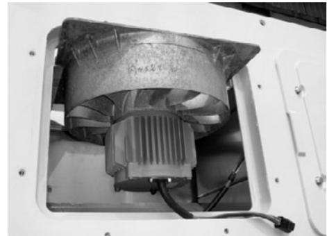
e) Remove fan diffuser and replace fan motor.
